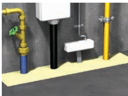
Zmiešané prestupy rozvodov
