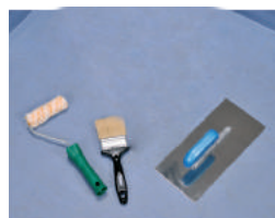
3 / Pripravíme si náradie – valček, štetec, oceľové hladítko.
