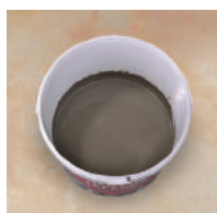
7 / Dôkladná homogenizácia oboch zložiek.
