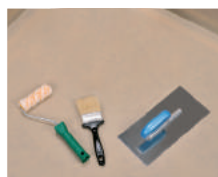
3 / Pripravíme si náradie – valček, štetec, oceľové hladítko.
