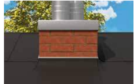
Tesnenie striech s asfaltovými izolačnými pásmi
