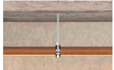
Zavesenie jednotlivých potrubí
