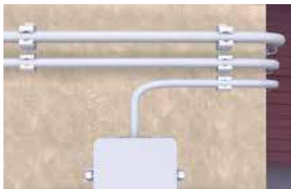
Upevnenie káblových trás
