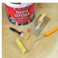
8 / Pripravíme si náradie – valček, štetec, oceľové hladítko.
