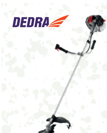
DEDRA BENZÍNOVÝ VYŽINAČ DED8717 Výkon 1,45 kW, 2-taktný motor 52 cm 3 , záber kotúč 25,5 cm/struna 44 cm, struna 2-2,4 mm hmotnosť 8 kg
